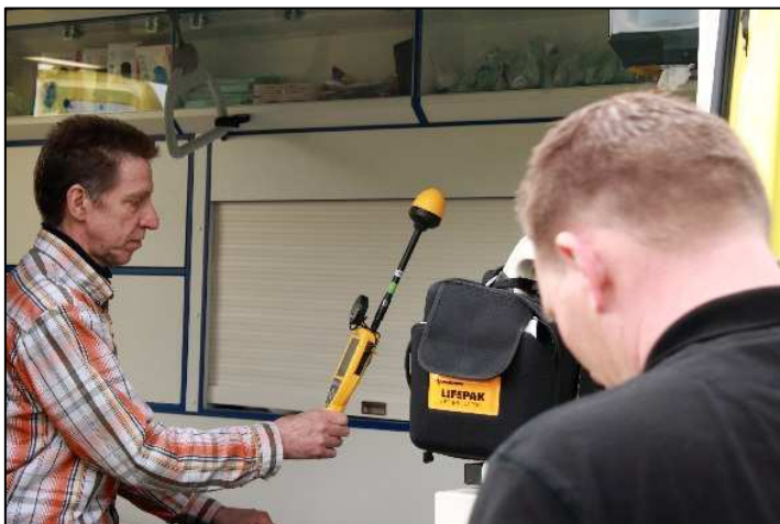
Foto 2: Breedbandmeting in ambulance voertuig
